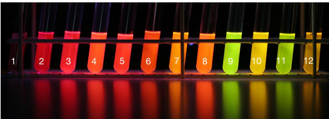
**Abbildung 7:** Solvatochromie von Nilrot in verschiedenen Lösungsmitteln.
